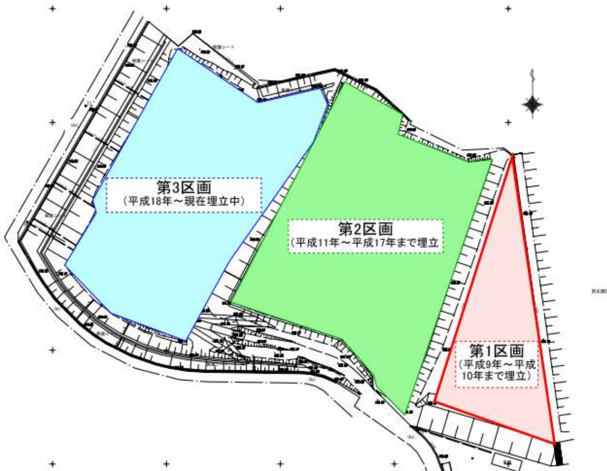
図 3-6 仙南最終処分場の埋立状況
