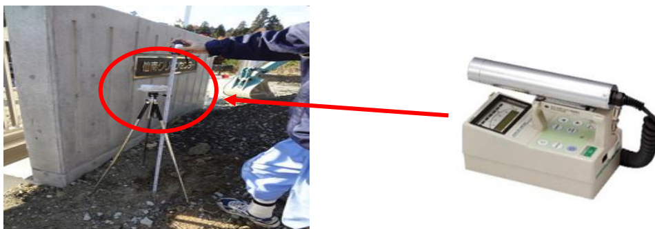
図 4.3.1-1 空間線量率測定方法
