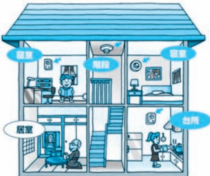
この図は代表的な2階建て住宅における住宅用火災警報器の設置例です。全ての寝室、台所、階段部分に設置が必要です。（居室への設置も推奨いたします）
