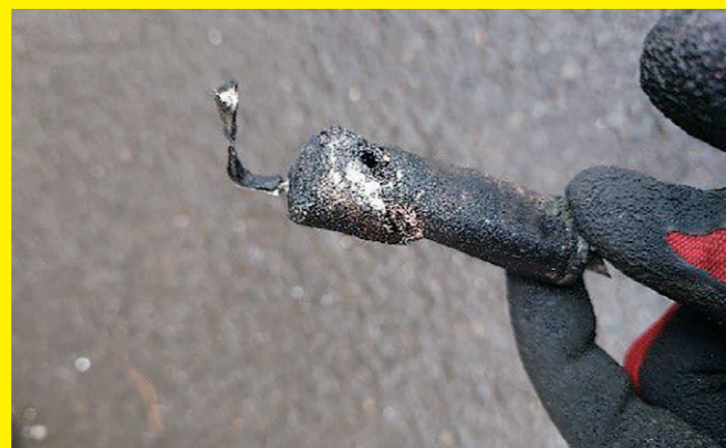
▲実際に仙南リサイクルセンターで燃えたリチウムイオン電池
